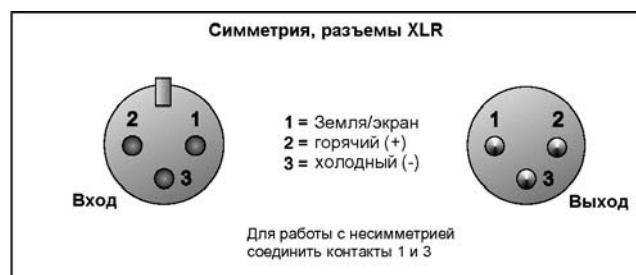
Рис. 5.1: балансная коммутация на разъемах XLR
