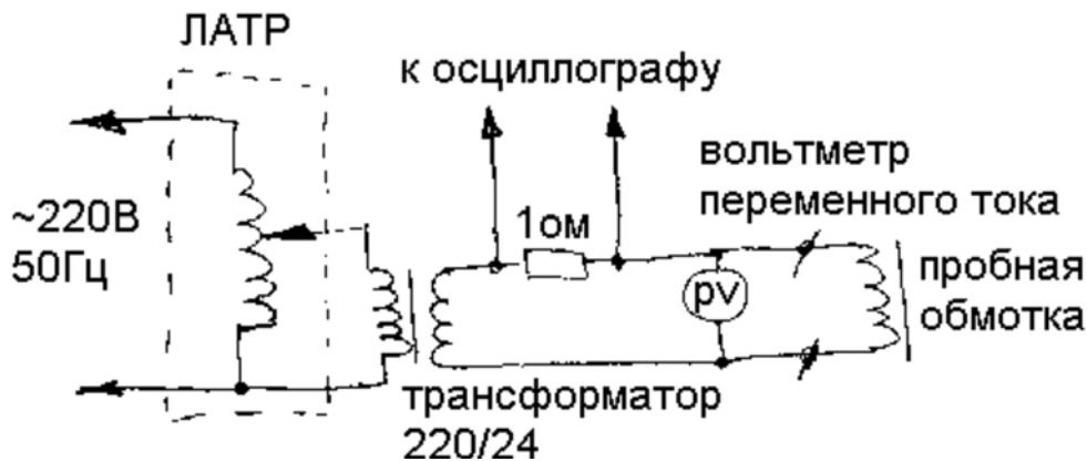
Рис. 2 Схема для измерения максимальной индукции в магнитопроводе
